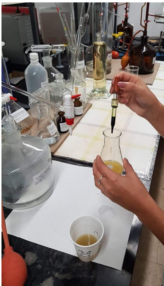
Slika 10. Metoda neutralizacije pomoću 0,1 M otopine NaOH uz indikator bromtimol plavi (Izvor: Mesarić, 2018.)
