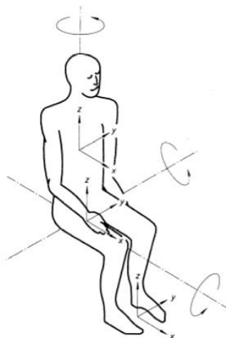
Slika 15. Prikaz koordinatnog sustava za određeni dio vibracija trupa u sjedećem položaju (Izvor: HRN ISO 2631-1, 1999.)
