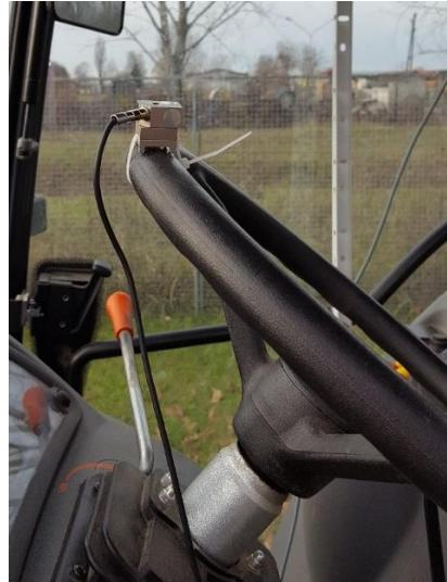
Slika 13. Postavljen senzor za mjerjenje vibracija koje utječu na sustav ruka-šaka rukovatelja
