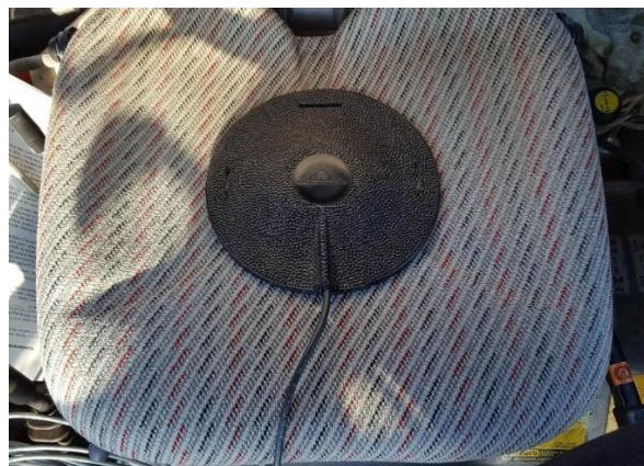
Slika 12. Postavljeni senzor za mjerjenje vibracija koje utječu na trup rukovatelja
