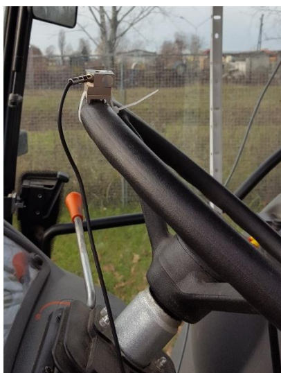
Slika 13. Postavljen senzor za mjerenje vibracija koje utječu na sustav ruka-šaka rukovatelja
