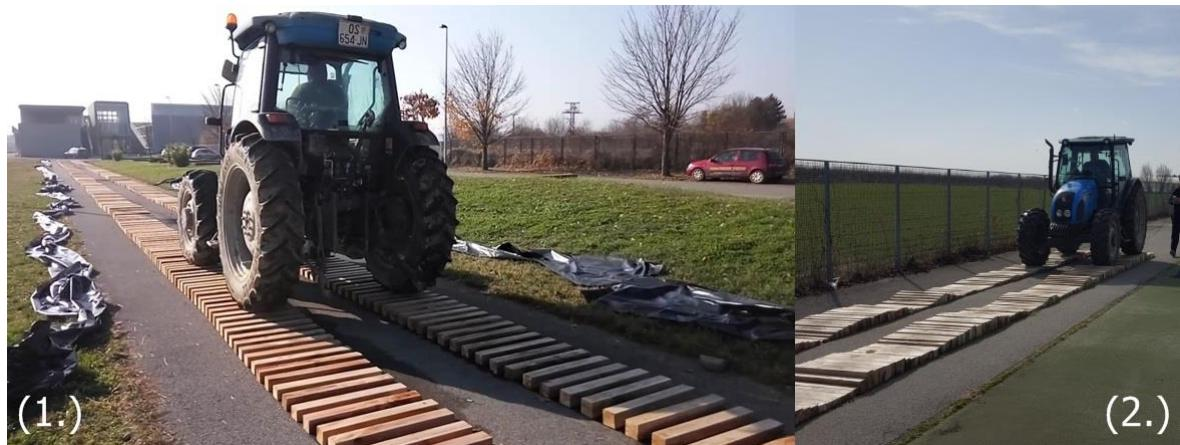
Slika 4. Testne trake (glatka (1.) i gruba (2.))
