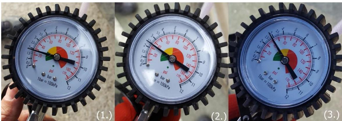
Slika 6. Tlak zraka u pneumaticima pri svim mjerjenjima (1,9 bar (1.), 2,4 bar (2.) i 2,9 bar
