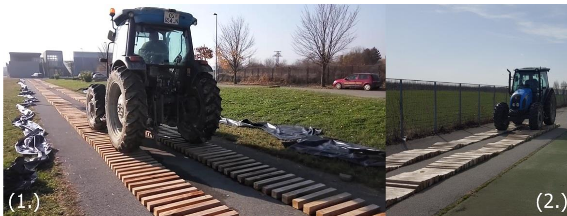
Slika 4. Testne trake (glatka (1.) i gruba (2.))
