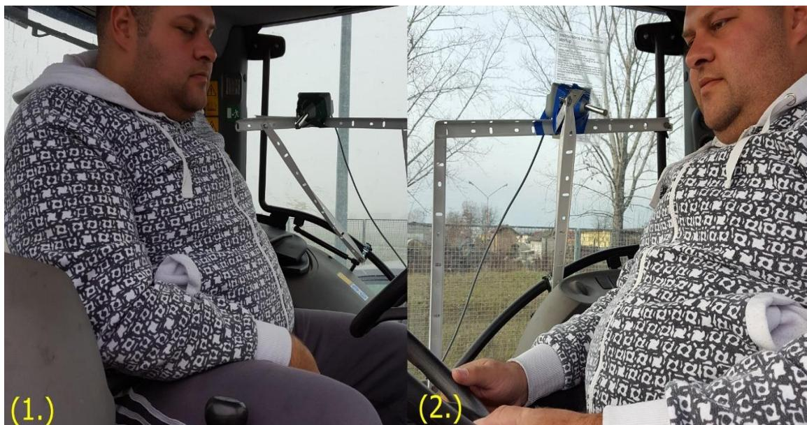
Slika 8. Postavljeni zvukomjer s lijeve (1.) i s desne (2.) strane pri mjerenu na trakama i agrotehničkim podlogama
