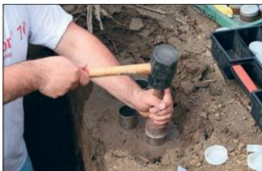
Slika 3. Utiskivanje cilindra po Kopeckom, (Lončarić i sur. 2014.)
