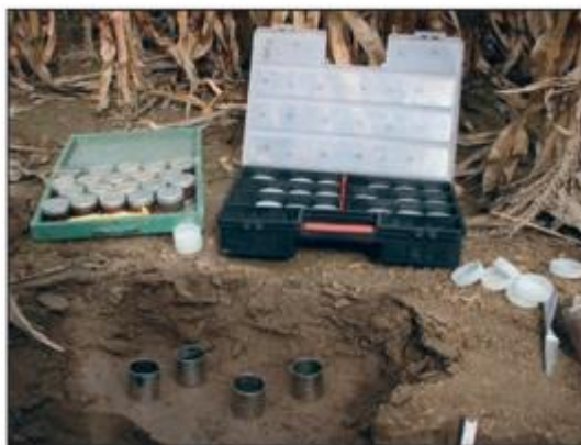
Slika 2. Cilindri po Kopeckom, (Lončarić i sur. 2014.)
