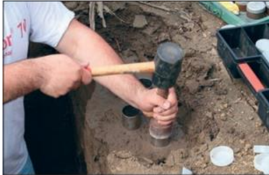
Slika 3. Utiskivanje cilindra po Kopeckom, (Lončarić i sur. 2014.)
