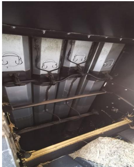
Slika 9. Donja zatvorena klizna površina slamotresa
