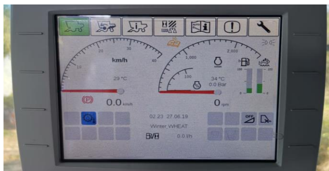
Slika 20. Monitor na kombajnu „ Rostselmash VECTOR 425 “
