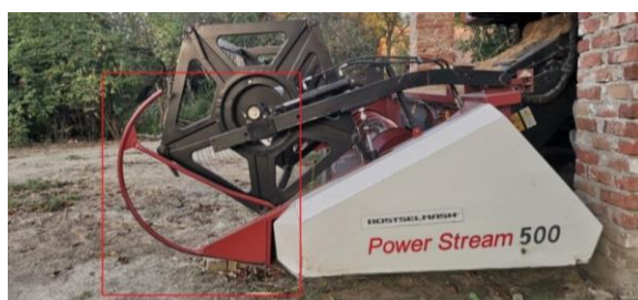
Slika 5. Razdjeljivač na hederu „Power Stream500“
