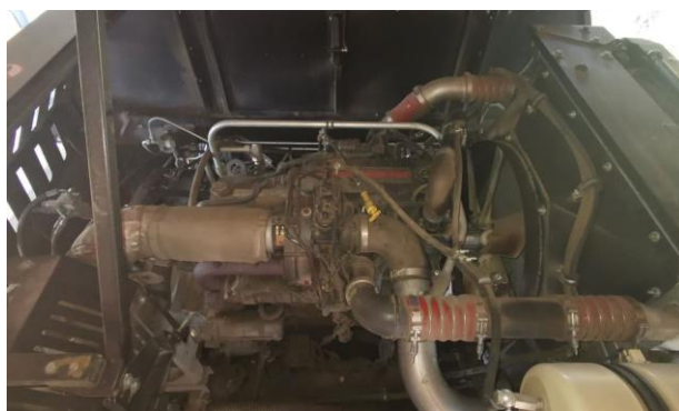
Slika 17. Motor Cummins kombajna „ Rostselmash VECTOR 425 “ (Izvor: Vlastita fotografija)
