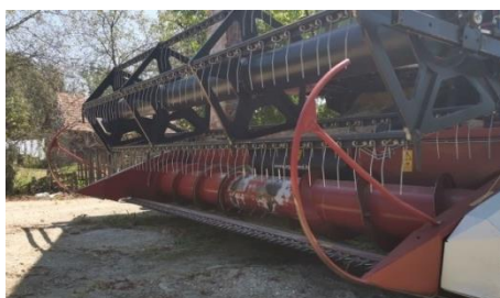
Slika 22. Položaj motovila kod stojećeg usjeva (Izvor: Vlastita fotografija)
