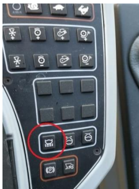
Slika 16. Tipka za uključivanje hidropulzatora (Izvor: Vlastita fotografija)
