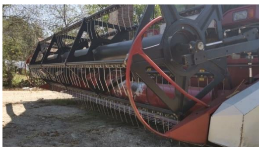
Slika 23. Položaj motovila kod poplegnutog usjeva (Izvor: Vlastita fotografija)
