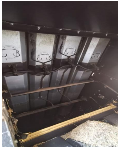
Slika 9. Donja zatvorena klizna površina slamotresa
