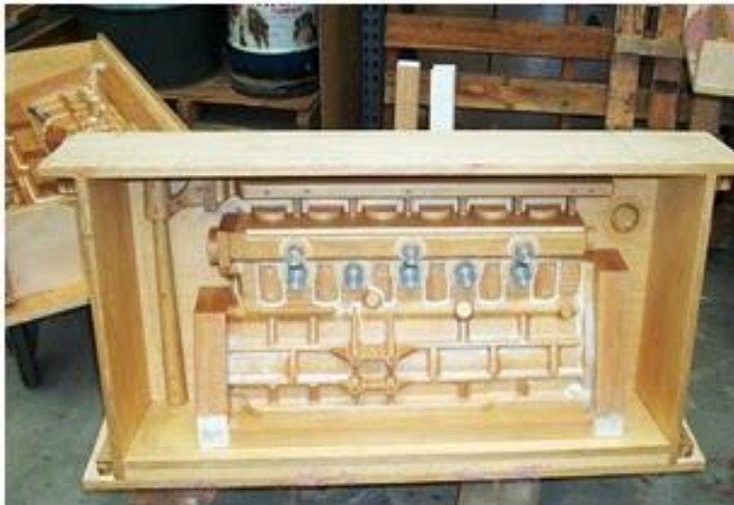
Slika 14. Model unutrašnjeg oblika kućišta motora
