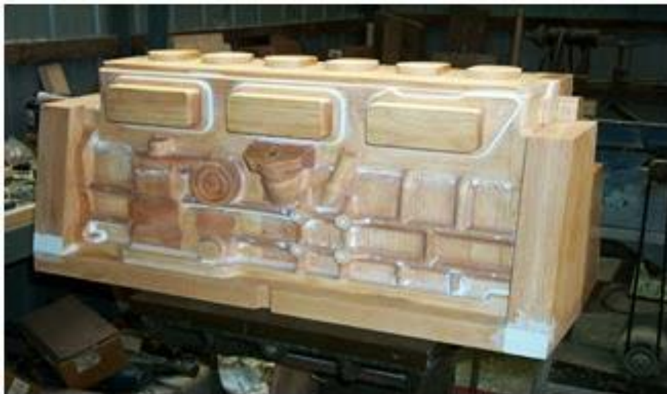
Slika 12. Drveni model vanjskih ploha motora
