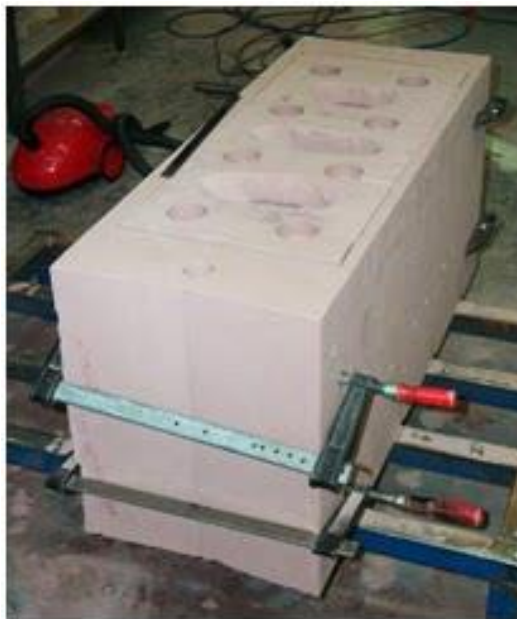
Slika 18. Cjelokupni kalup kućišta motora pripremljen za postupak lijevanja
