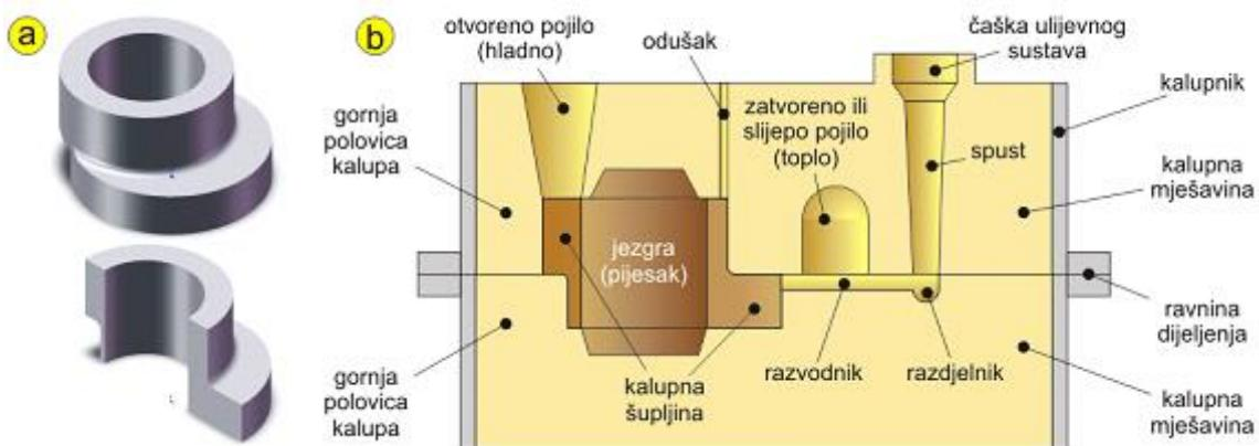
Slika 6. Odljevaci i pješčani kalup u kalupniku
