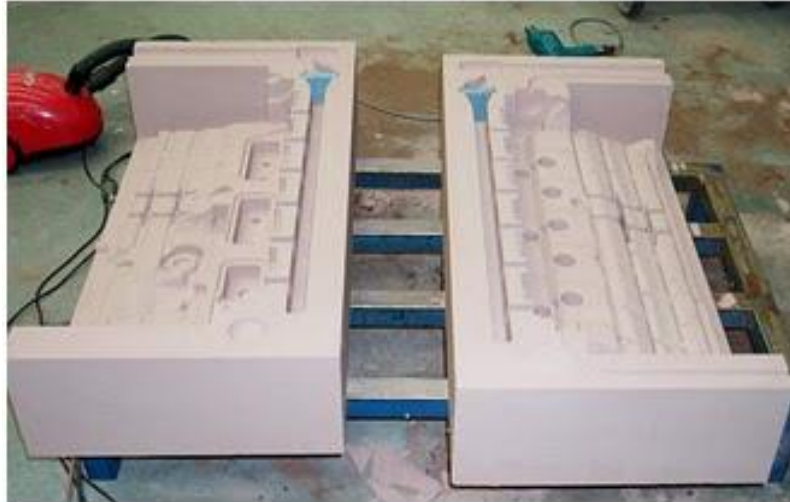
Slika 13. Stranice pješčanog kalupa vanjskih ploha kućišta motora
