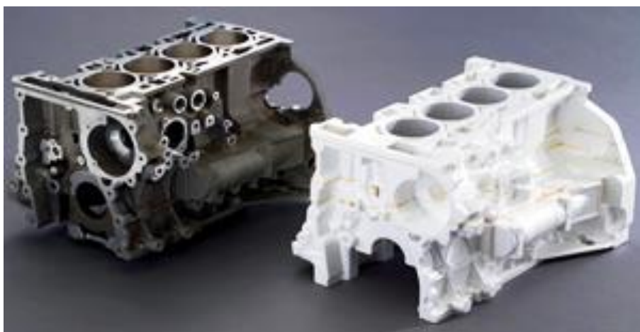
Slika 21. Kućište motora i isparljivi model kućišta
