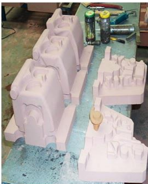
Slika 15. Pješčani kalupi unutrašnjih ploha kućišta motora
