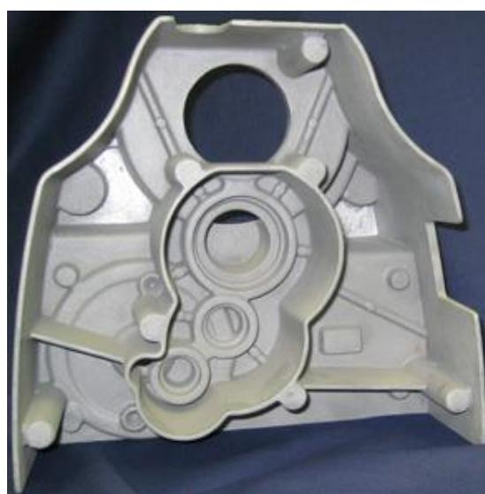
Slika 9. Al-odljevak iz gipsanog kalupa
