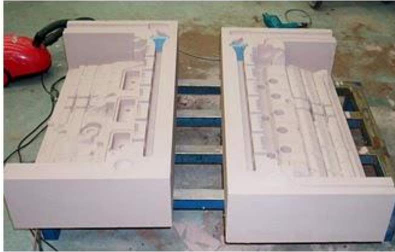
Slika 13. Stranice pješčanog kalupa vanjskih ploha kućišta motora
