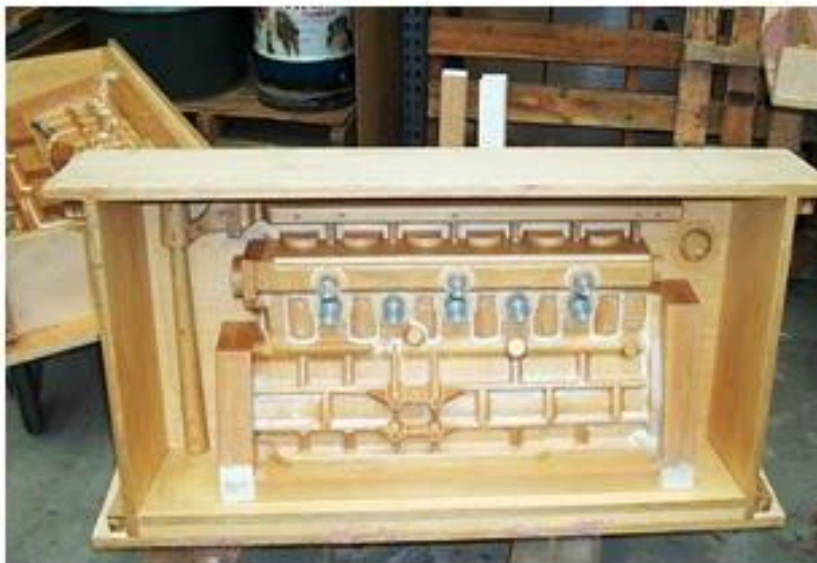
Slika 14. Model unutrašnjeg oblika kućišta motora
