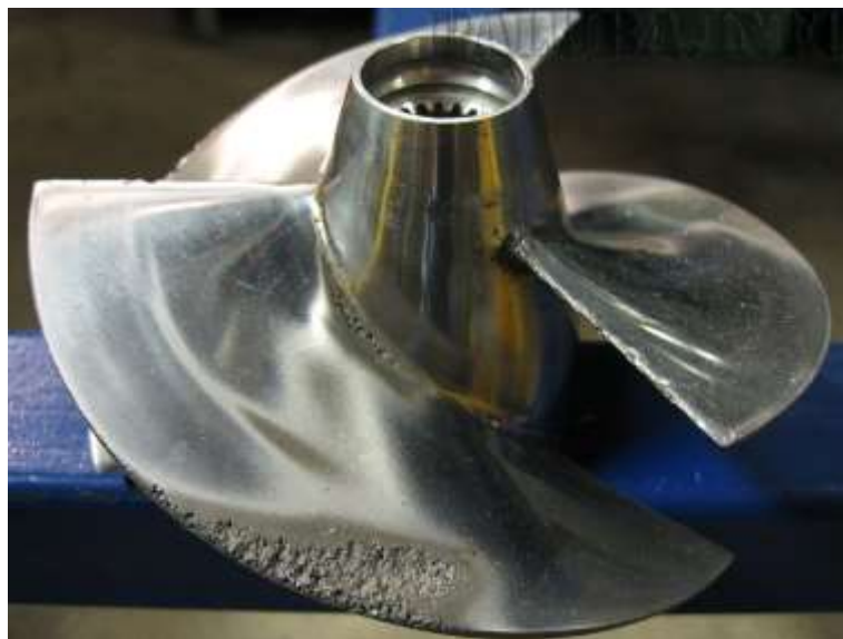
Slika 12. Kavitacijsko trošenje broskog vijka (Izvor: http://www.paluba.info )
