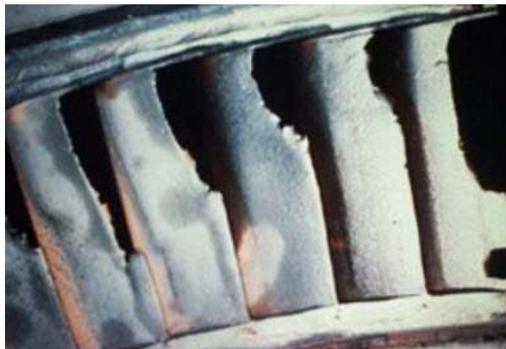
Slika 10. Erozija lopatica crpke za transport tekućih tvari (Izvor: https://www.ansys.com )
