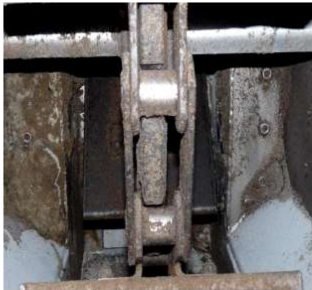
Slika 8. Tribokorozija lanca elevatora (Izvor: Rozing i sur., 2015.)
