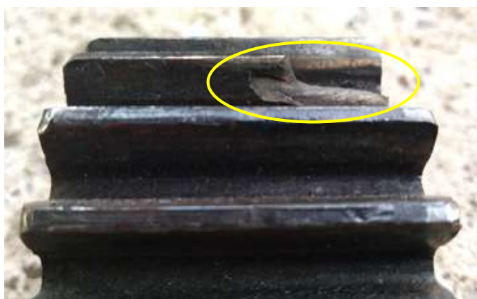
Slika 25. Lom rubnog dijela zuba planetarnog zupčanika (Izvor: Dario Raić, 2019.)
