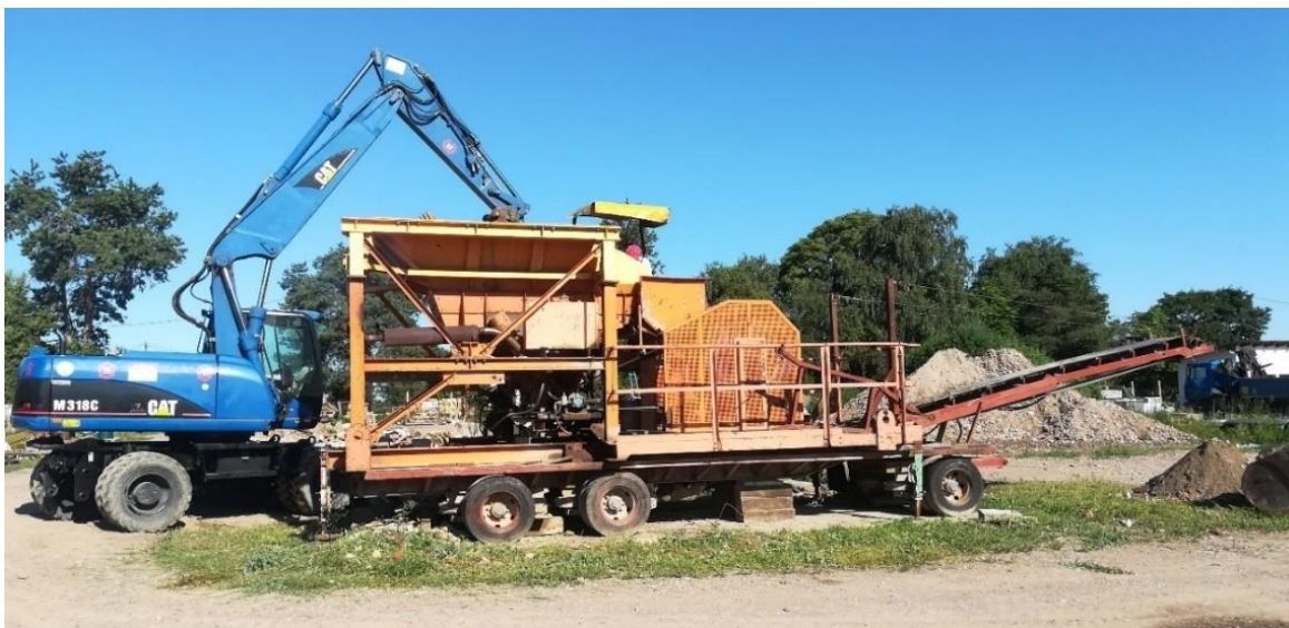
Slika 5. Drobilica građevinskog materijala (Izvor: Vlastita fotografija)
