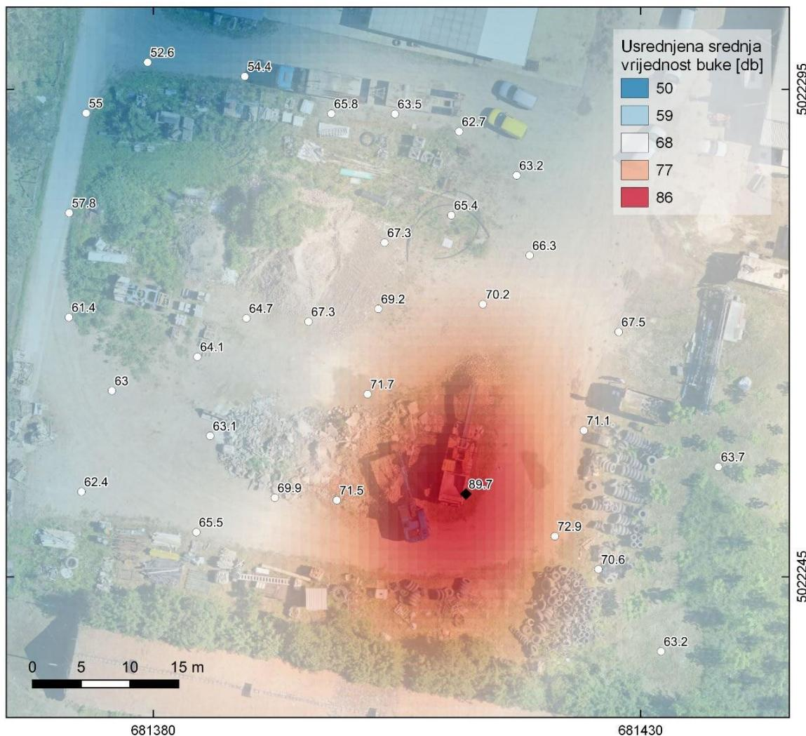
Slika 17. Točke mjerena s pripadajućim prosječnim vrijednostima prikazane 2D kartom
