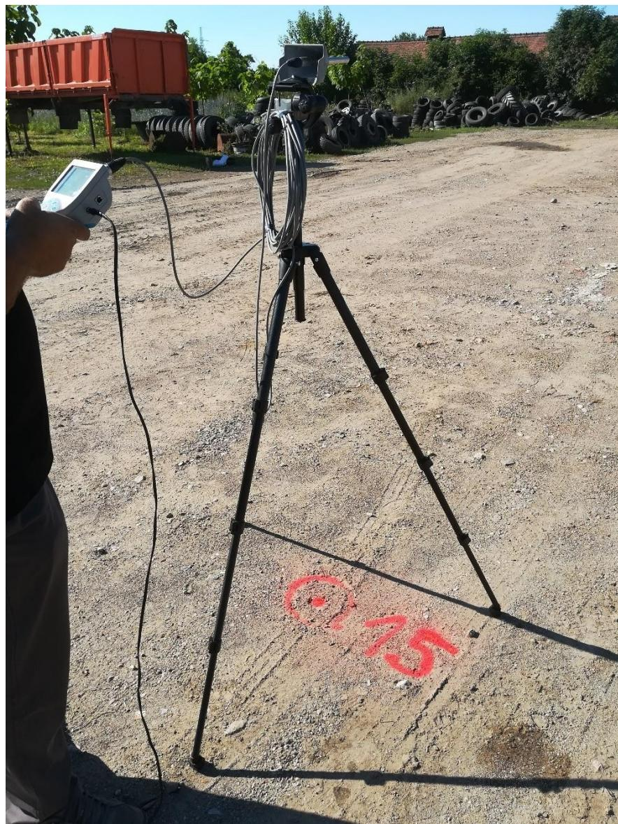
Slika 8. Uređaj za mjerenje buke Metrel Multinorm MI 6201 s pripadajućim mikrofonom
