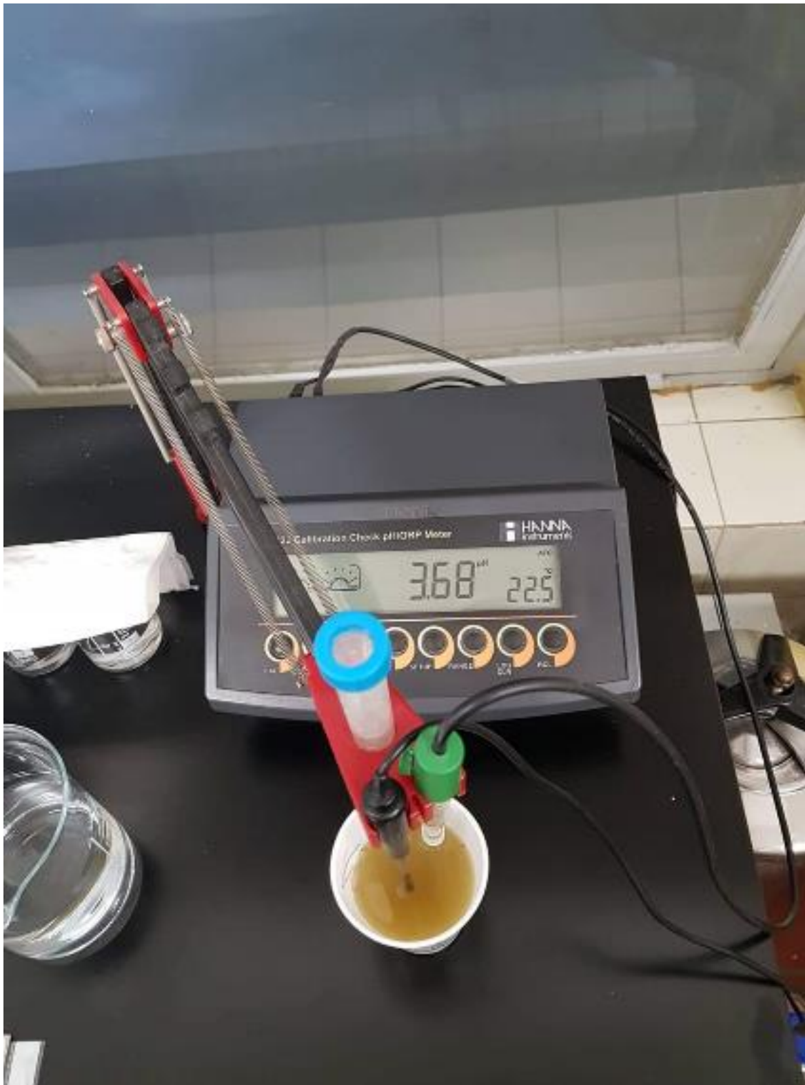
Slika 11. Mjerenje realnog aciditeta mošta (Izvor: Mesarić, 2018.)
