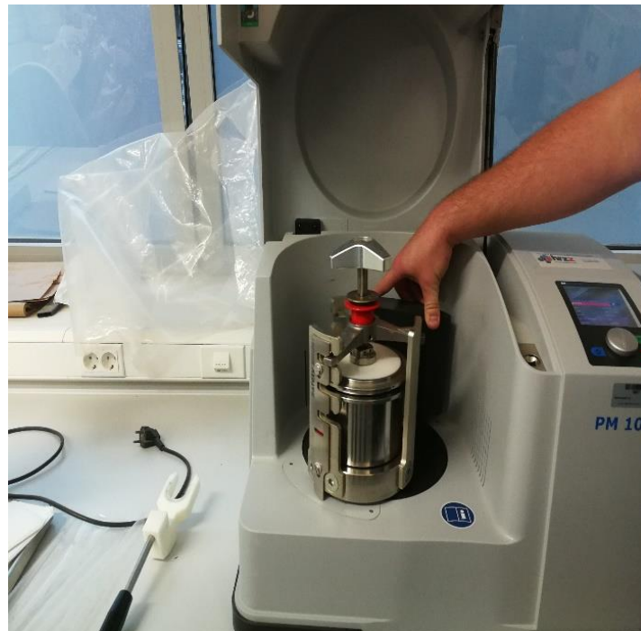
Slika 6. Cilindrični mlin Retsch PM 100 ® (izvor: D. Lončar)
