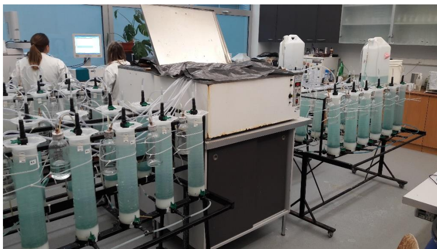
Slika 8. Provedba procesa anaerobne fermentacije
