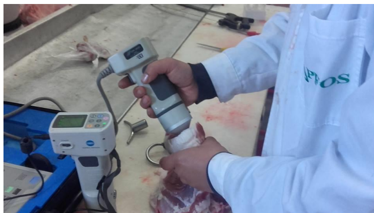
Slika 113. Određivanje boje mesa pomoću Minolta kolorimetra
