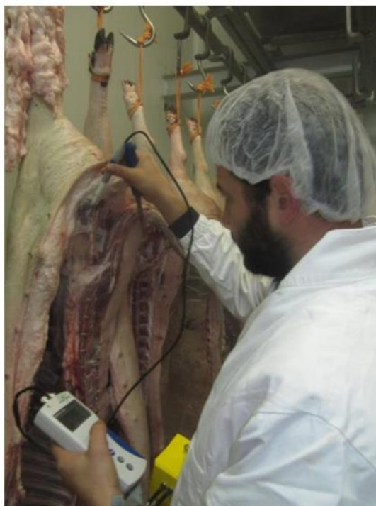
Slika 9. Mjerenje pH vrijednosti u butu
