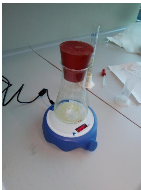
Slika 8. Miješanje svih komponenti magnetskom mješalicom (izvor: N. Cecelja)
