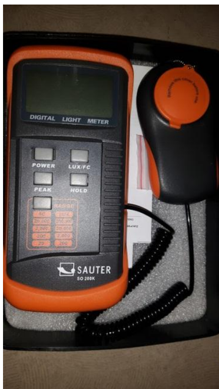
Slika 7. Uredaj za mjerenje sunčevog zračenja (izvor: autor)
