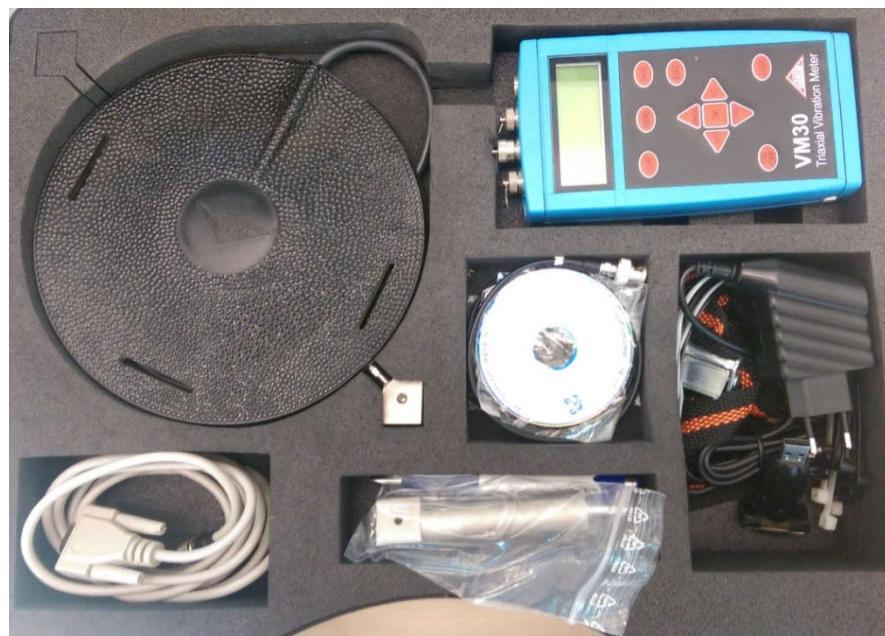
Slika 5. Uređaj za mjerjenje traktorskih vibracija *MMF VM 30* (izvor: vlastita fotografija)
