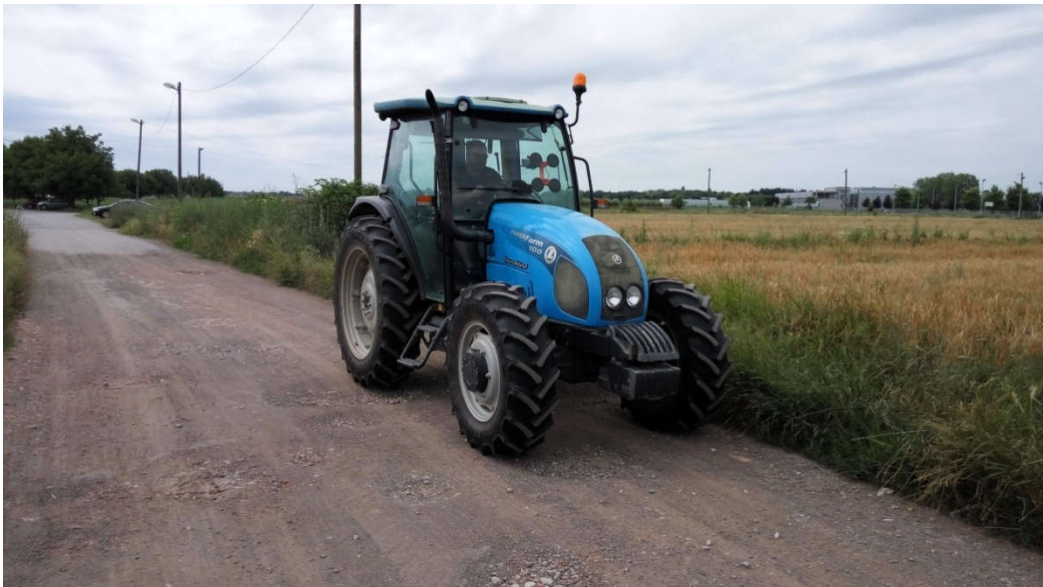
Slika 7. Mjerenje razine traktorskih vibracija na makadamu (izvor: vlastita fotografija)
