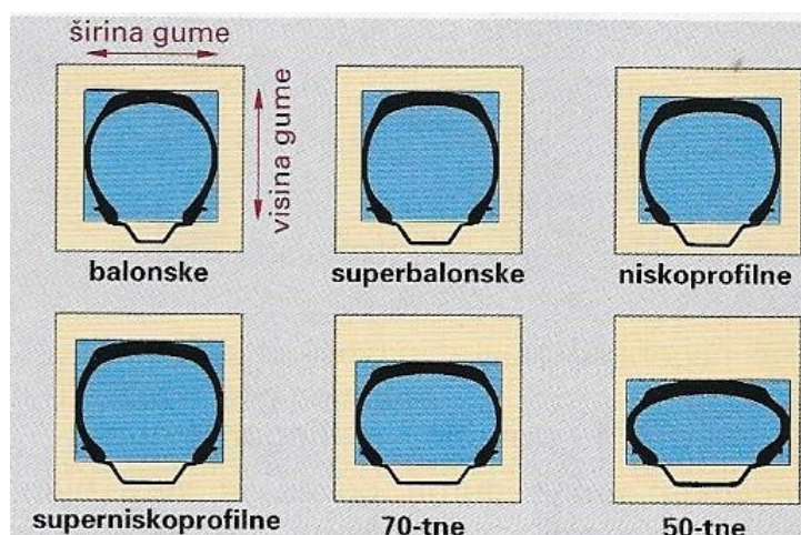
Slika 22. Oblici profila pneumatika (Izvor: Popović, 2010.).
