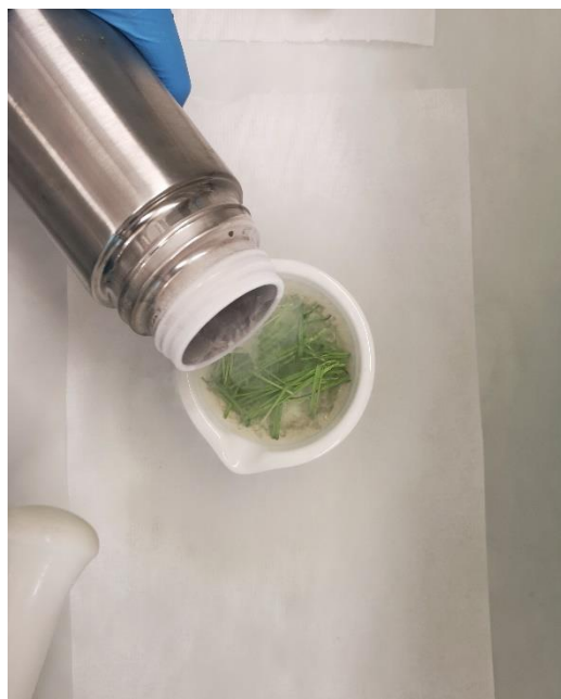
Slika 9. Maceriranje lisne mase tekućim dušikom
