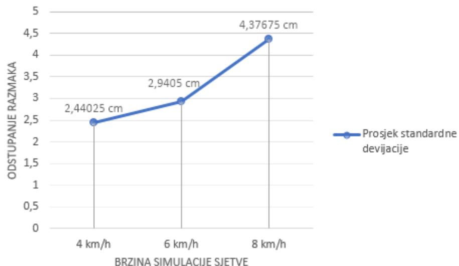
*Teorijski razmak kombinacije 12:19 – 22,334 cm,  $i = i = 0,30409$ , Sjetvena ploča  $n=24 \text{ ø } 4,5 \text{ mm}$ ,  $D_d=47,8 \text{ cm}$ , položaj skidača viška sjemena=8;  $z_l=18$ ;*
