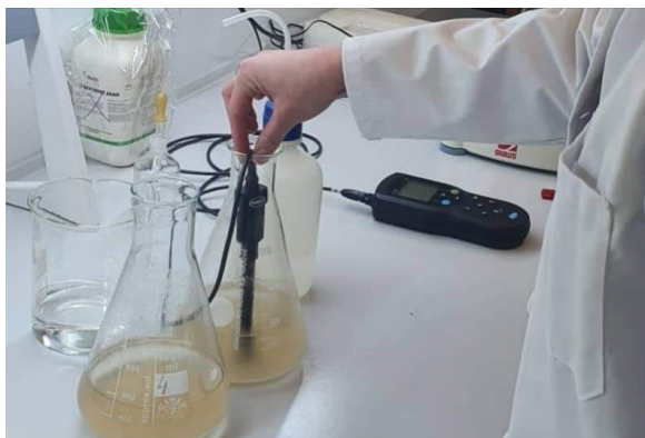
Slika 2. Mjerenje pH vrijednosti hranjive podloge
