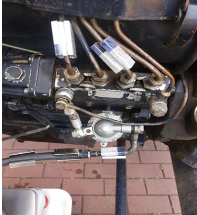
Slika 8. Magneti za uštedu goriva
