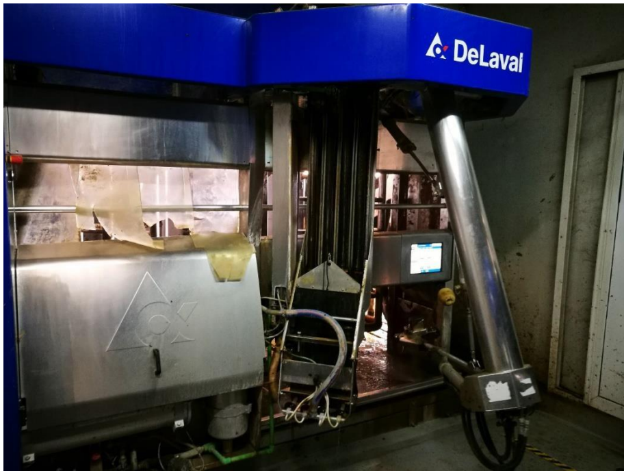
Slika 4. Robot za mužnju na farmi Topolik (Izvor: T. Bobić)
