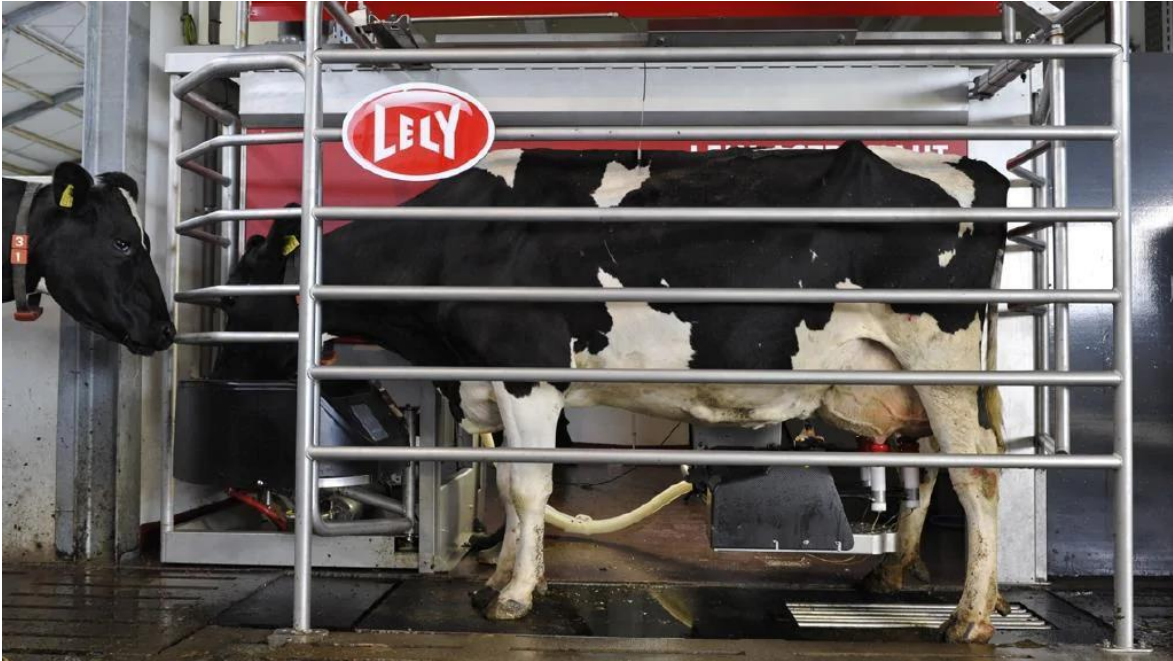
Slika 2. Automatizirani muzni sustav marke Lely
