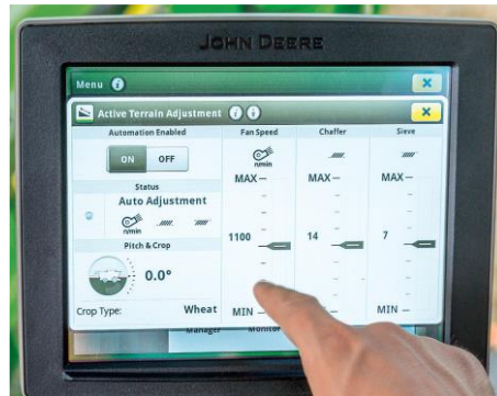
Slika 9. Informacijski zaslon na ombajnu John Deere
