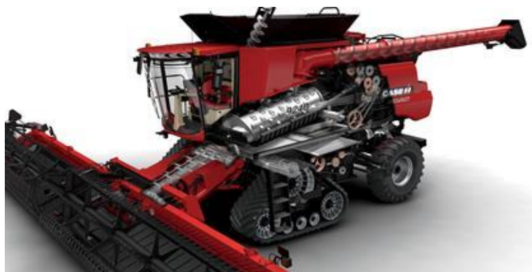
Slika 13. Prikaz kombajna s aksijalnim sustavom izvršavanja
