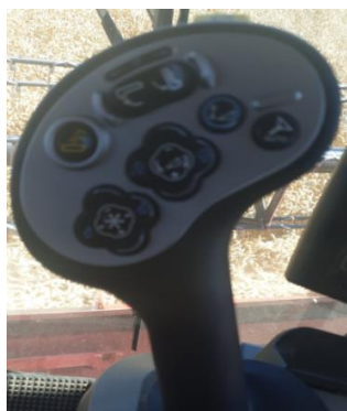
Slika 17. Upravljačka palica s najbitnijim funkcijama za podešavanje
