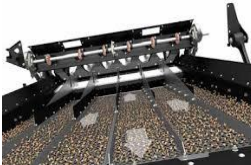
Slika 12. Rad na nagnutim terenima s sustavom za čišćenje X Flow
