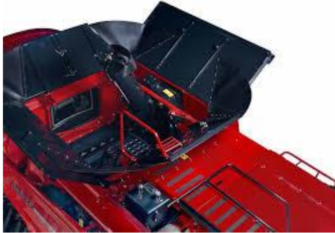
Slika 13. Spremnik za zrno kombajna Case IH 7140
