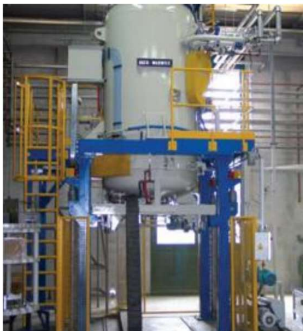
Slika 26. Vertikalna vakuumska peć sa spuštajućim dnom
