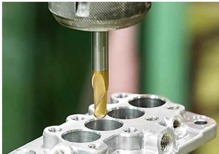
Slika 9. Bušenje rupa za pričvrsne vijke aluminijске glave motora
