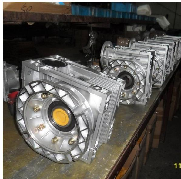
Slika 22. Kućište reduktora
