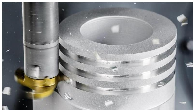
Slika 8. Glodanje aluminijskog klipa motora SUS
