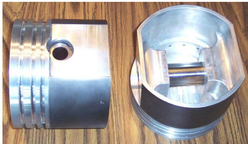
Slika 20. Aluminijski klipovi motora traktora John Deere
