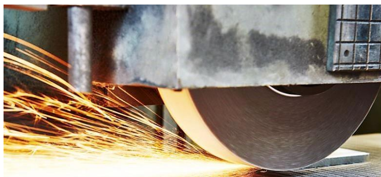
Slika 10. Ravno brušenje aluminijskih ploča ( https://www.clintonaluminum.com/grinding-aluminum-sheets-and-plates/ )
