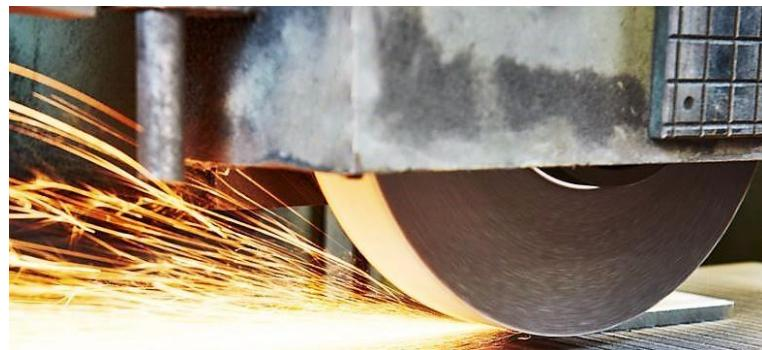
Slika 10. Ravno brušenje aluminijskih ploča
