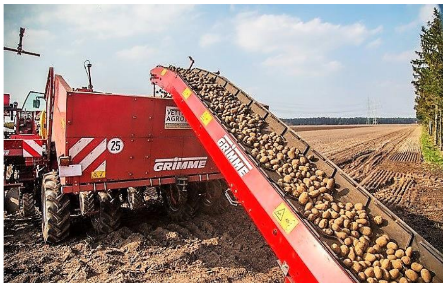
Slika 16. Gumena traka transportera za krumpir (Izvor:
