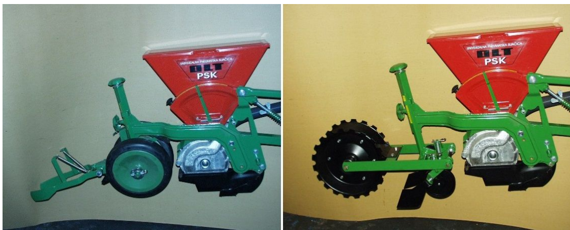
Slika 8. Različite izvedbe sjetvenih sekcija za sjetvu kukuruza
