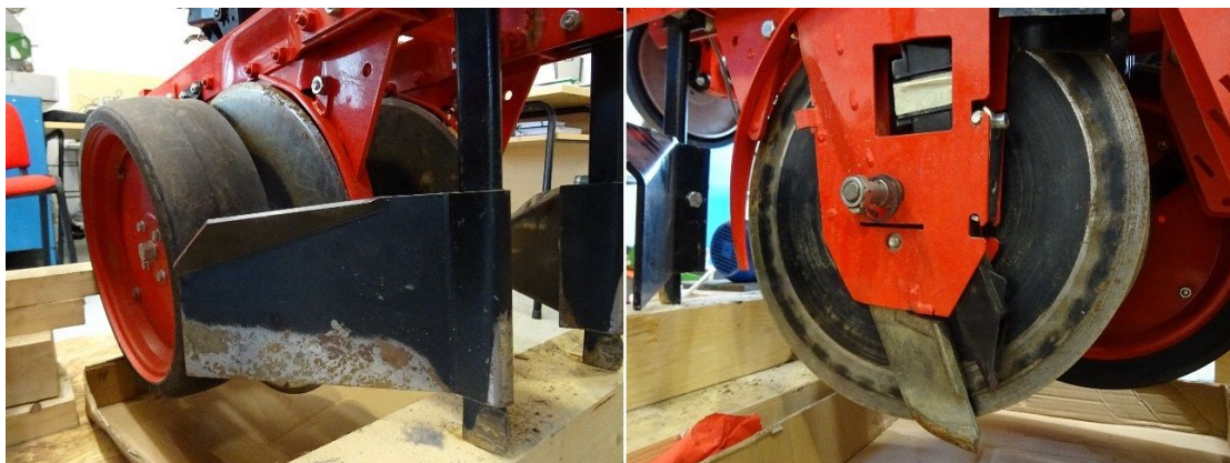
Slika 16. Uređaj za otklanjanje gruda tla u pravcu sjetve (lijevo) i provodna cijev za sjemena (desno)
