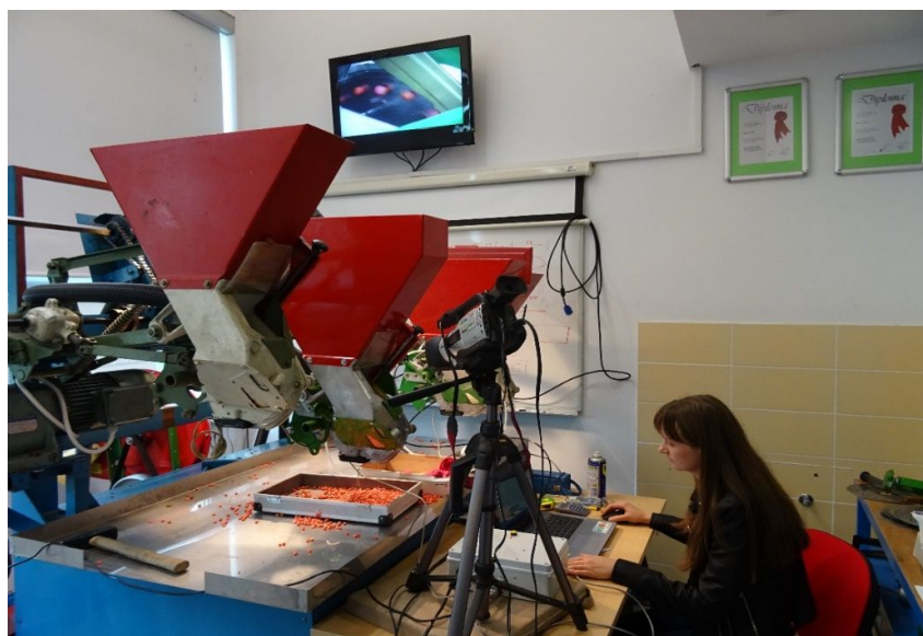
Slika 25. Ispitni stol za provjeru kvalitete rada pneumatskih sijačica
