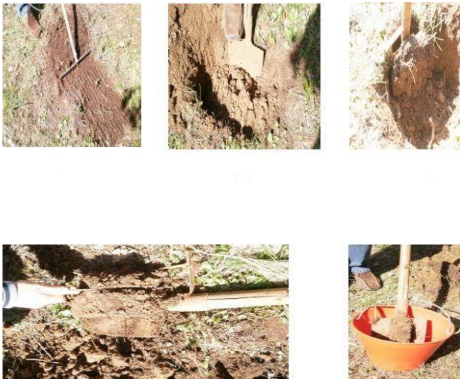
Slika 7. Uzorkovanje štihačom (ašovom) (FAZ, 2011).
