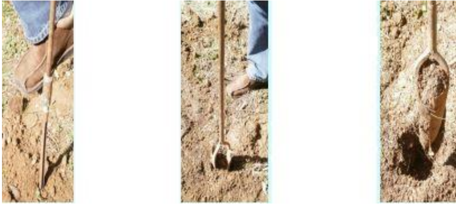
Slika 6. Uzorkovanje sondom i svrdlom (FAZ, 2011).
