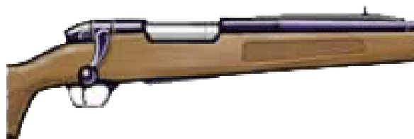
Slika 24. Cilindrični zatvarač sa korijenom ručice
