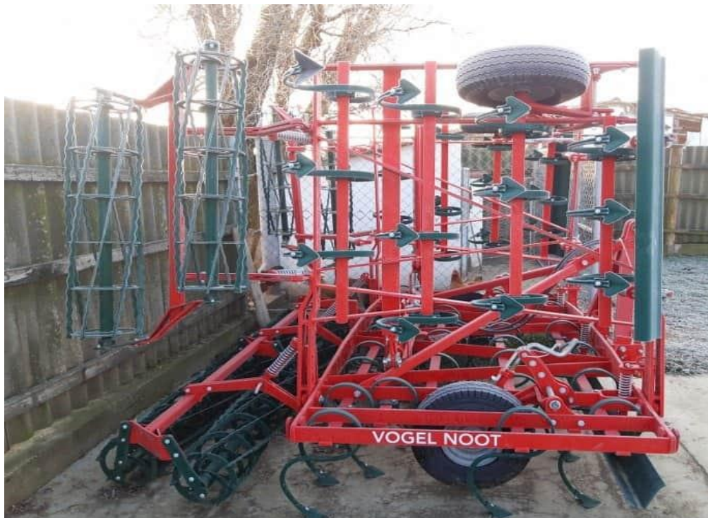
Slika 9. Sjetvospremač marke Vogel Noot
