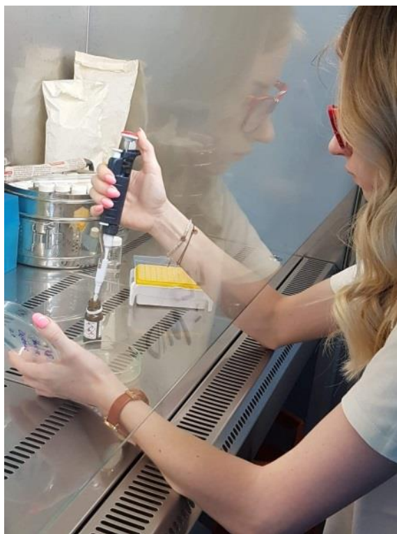
Slika 6. Pipetiranje eteričnog ulja na podlogu (Izvor: Petrić, 2019.)
