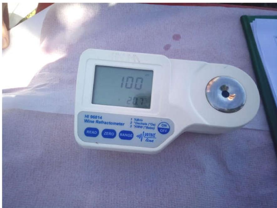
Slika 10. Digitalni refraktometar
