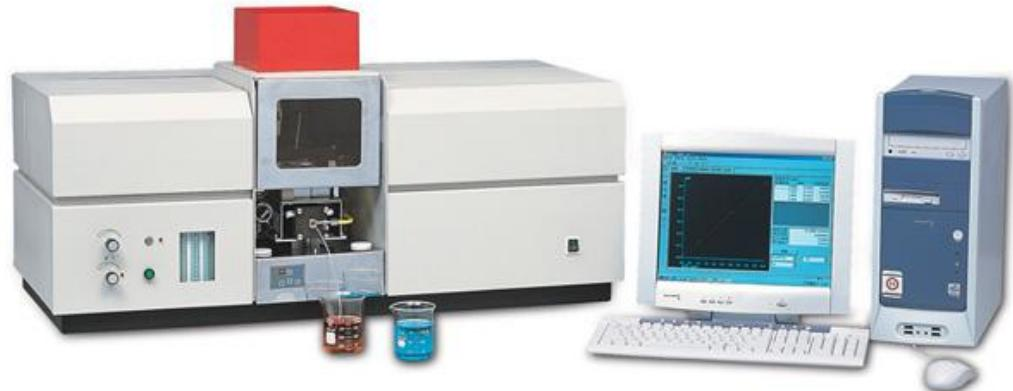
Slika 6.: Atomski apsorpcijski spektrofotometar
