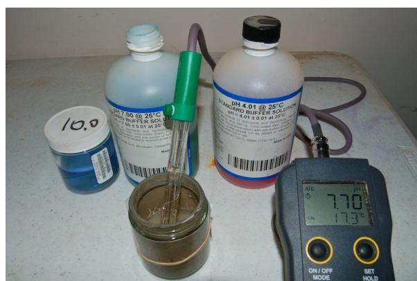
Slika 2.: Elektrometrijsko mjerjenje pH metrom
