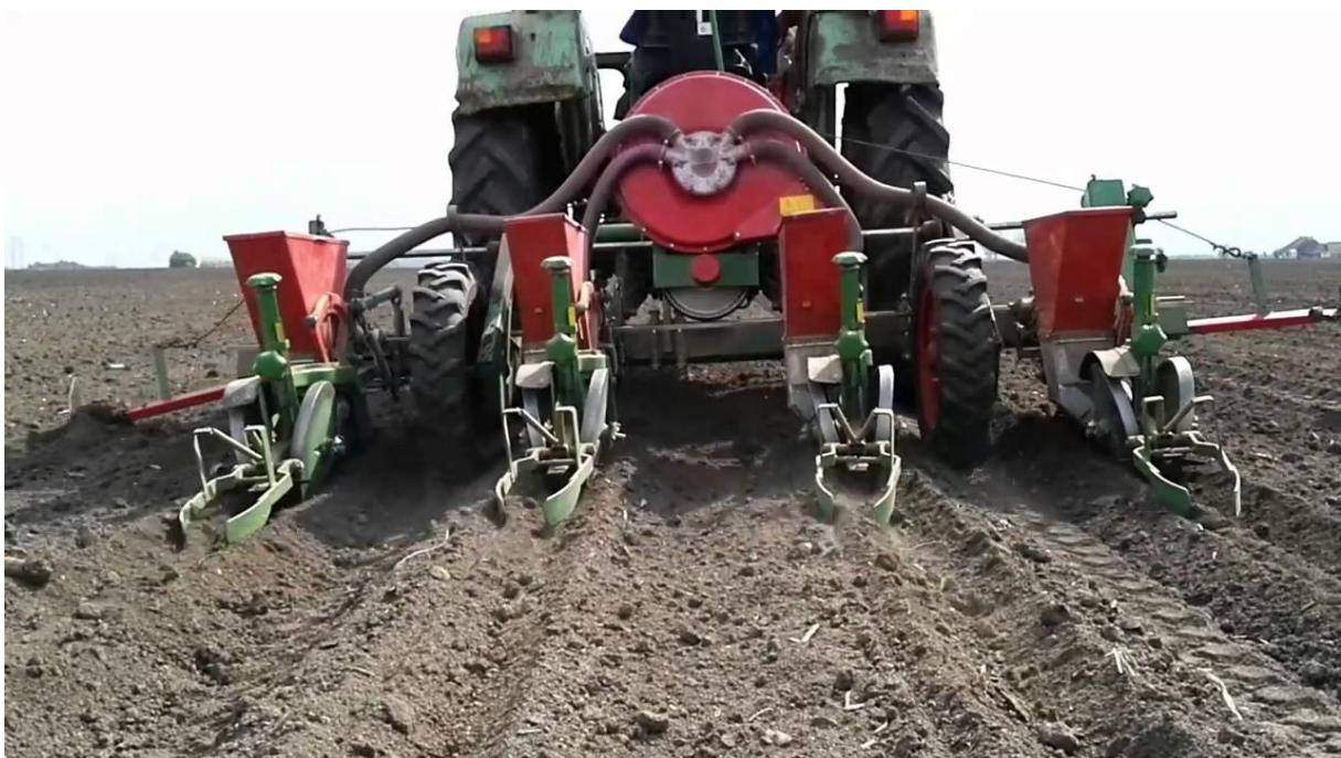
Slika 5. Pneumatska sijačica PSK4 (Izvor: A. Banaj)
