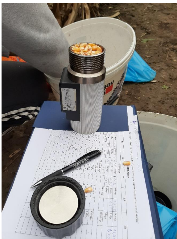
Slika 5. Vaganje klipa kukuruza i utvrđivanje vlage zrna (Izvor: Efinger, I.)
