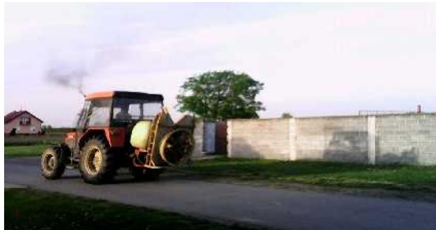
Slika 8. Nosivi traktorski raspršivači
