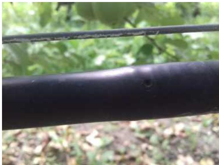
Slika 12. Predviđeni otvorovi (kapaljke) na plastičnim cijevima
