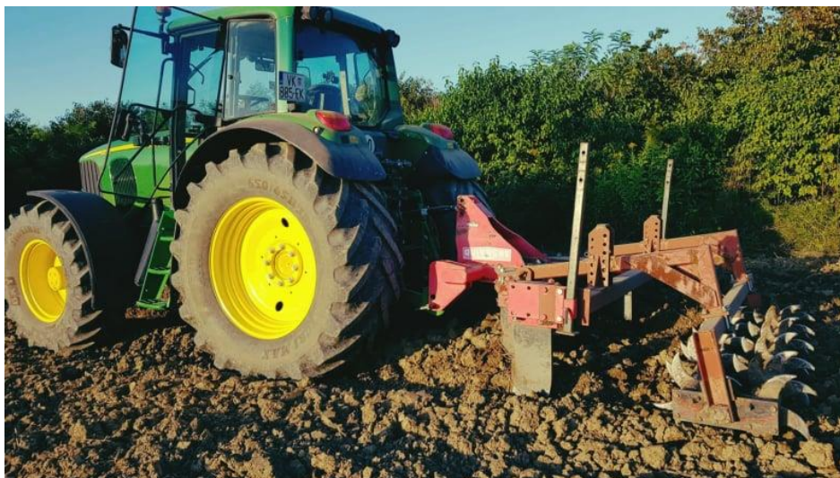
Slika 12. Podrivanje traktorom John Deere 6620 Premium i podrivačem Quivogne
