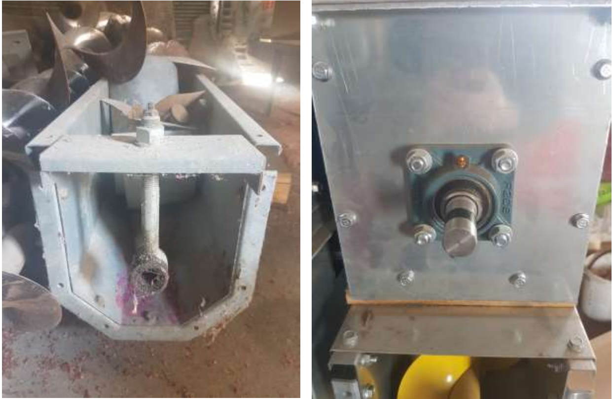
Slika 38. Unutarnji ležaj (lijevo) i čeonu ležaj (desno) (Izvor: Lukačević, M.)
