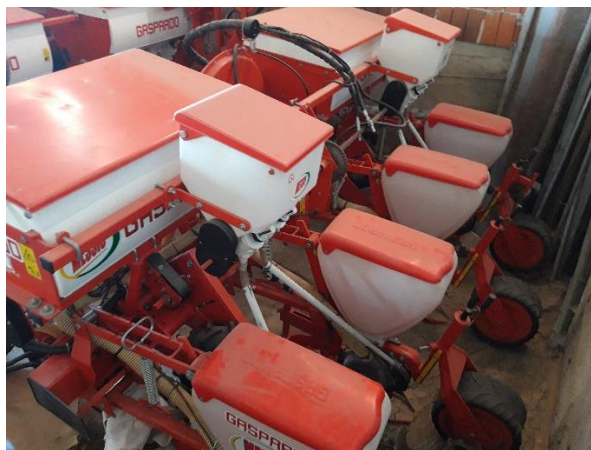
Slika 12. Sijačica za kukuruz „Gaspardo SP 540“ (vlastiti izvor)
