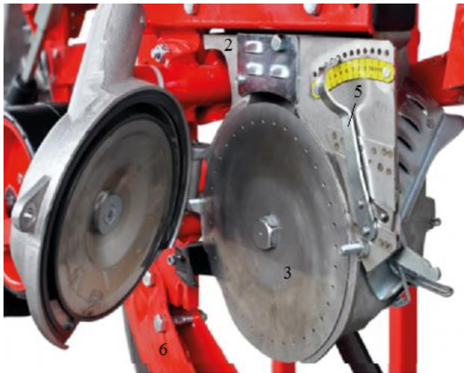
Slika 7. Pneumatski sjetveni uređaj s podtlakom, 2. Kućište sjetvenog uređaja, 3. Sjetvena pločica, 5. Čistač viška sjemena, 6. Ulagač sjemena [14]
