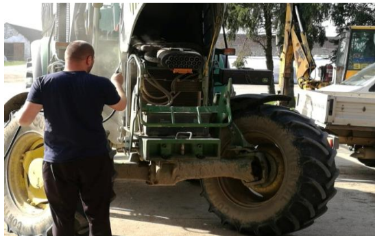
Slika 4: Ispirivanje komprimiranim zrakom nakon obavljanja posla. John Deere 6830
