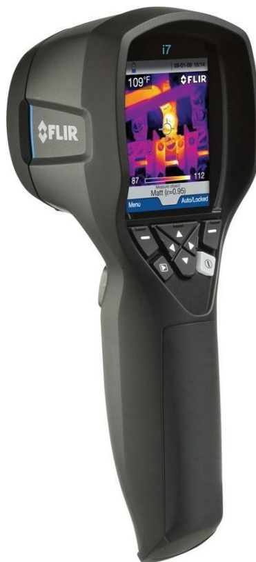
Slika 5. Infracrvena termovizijska kamera FLIR i7
