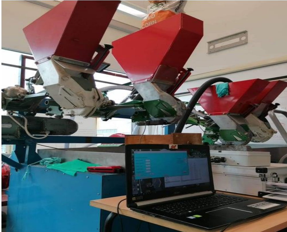
Slika 9. PSK - OLT sijačica na ispitnom stolu
