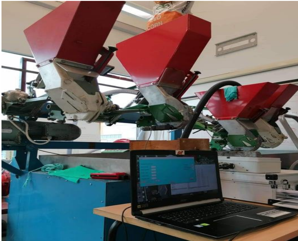
Slika 9. PSK - OLT sijačica na ispitnom stolu
