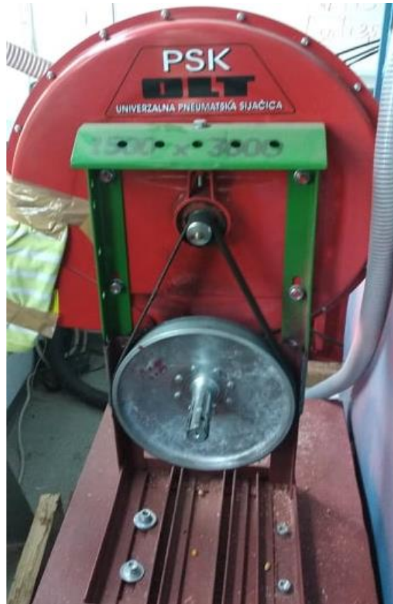
Slika 11. Prikaz pogonskog sustava ventilatora pri ispitivanju u laboratoriju
