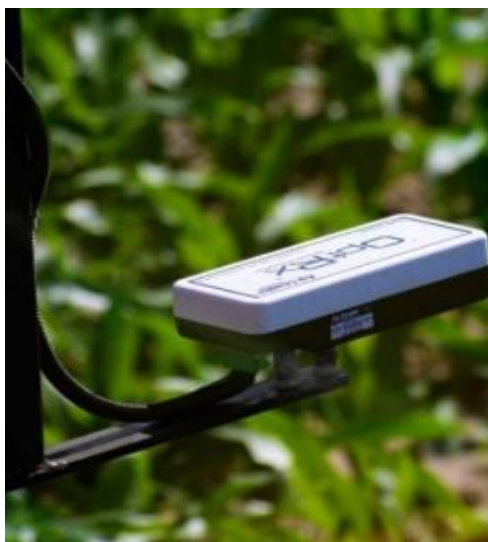
Slika 10. AgLeader OptRx senzor (Izvor: AgLeader
