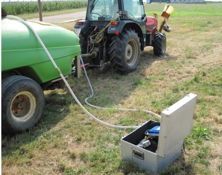
Slika 3. Mjerenje protoke crpke i vraćanje tekućine u spremnik raspršivača
