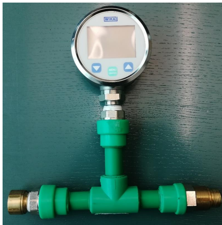
Slika 10. Kontrolni digitalni manometar s nosačem mlaznice
