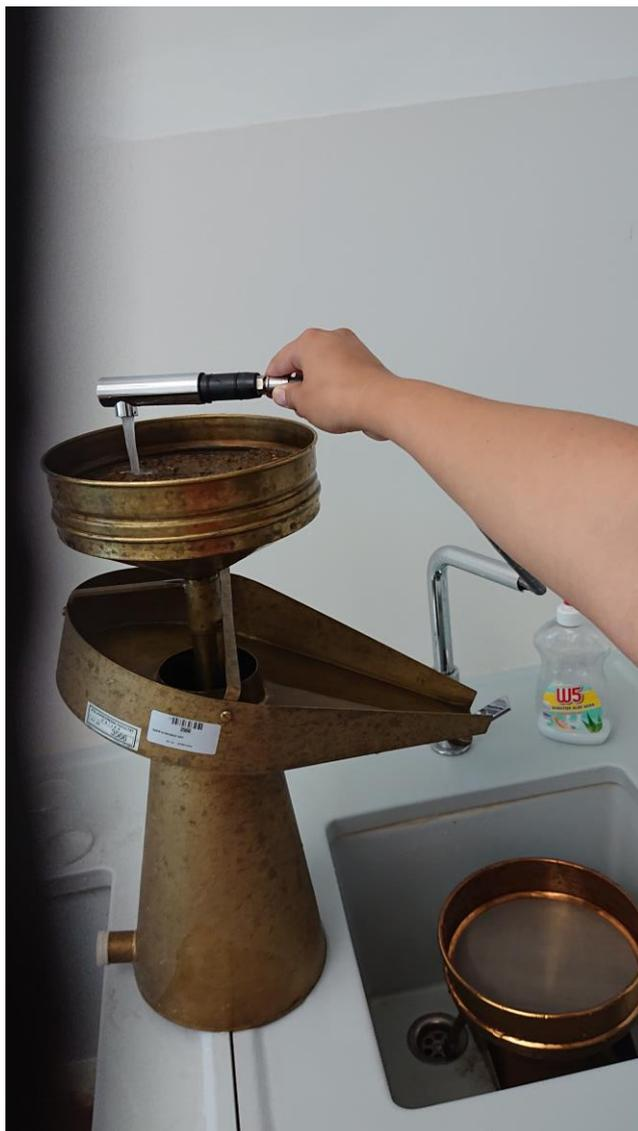
**Slika 12. Ispiranje uzoraka tla Fenwickovim aparatom**
