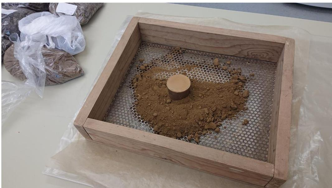
**Slika 10. Usitnjavanje uzoraka tla gumenim čepom, prije sušenja
