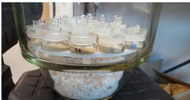
Slika 3.12. Hlađenje u vakuum eksikatoru (Izvor:Doris Doljanac)
