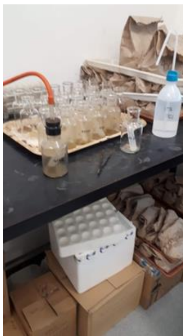
Slika 3.10. Volumetrijska metoda određivanja karbonata (Izvor:Doris Doljanac)
