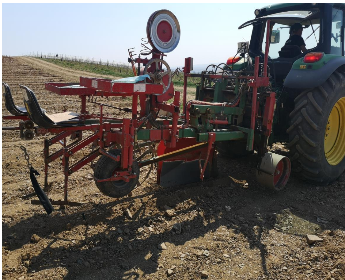
Slika 10. Strojna sadnja vinograda, Autor, 2020.
