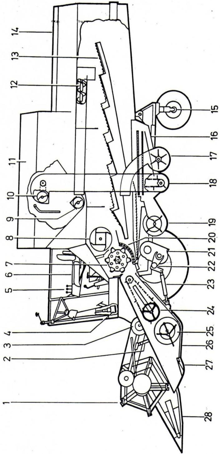
Slika 1. Dijelovi kombajna
