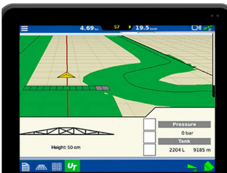
Slika 9. AutoSectionControl za automatsko otvaranje i zatvaranje mlaznica
