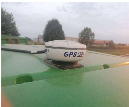
Slika 7. Antena na traktoru John Deere
