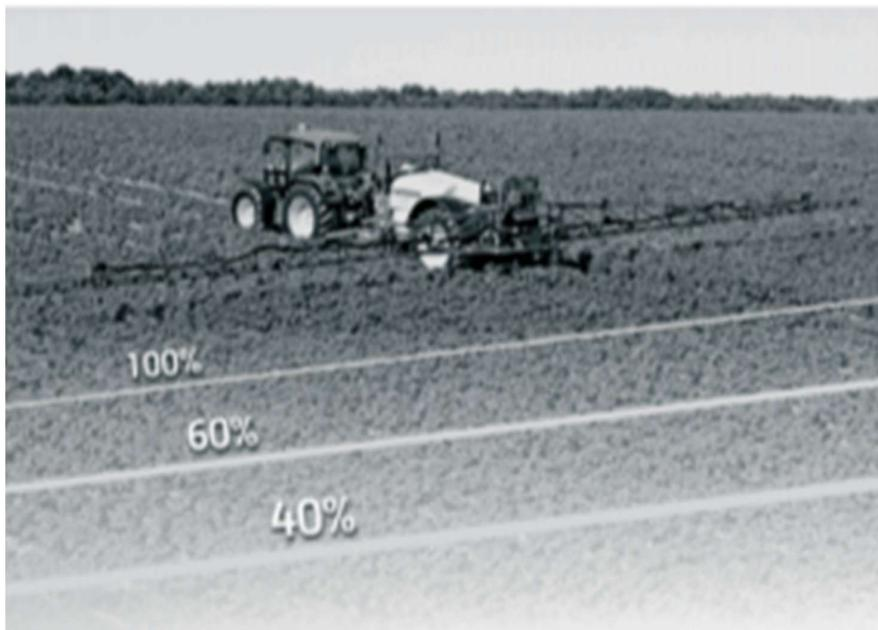
Slika 10. Tretiranje proizvodne površine promjenjivom količinom pesticida
