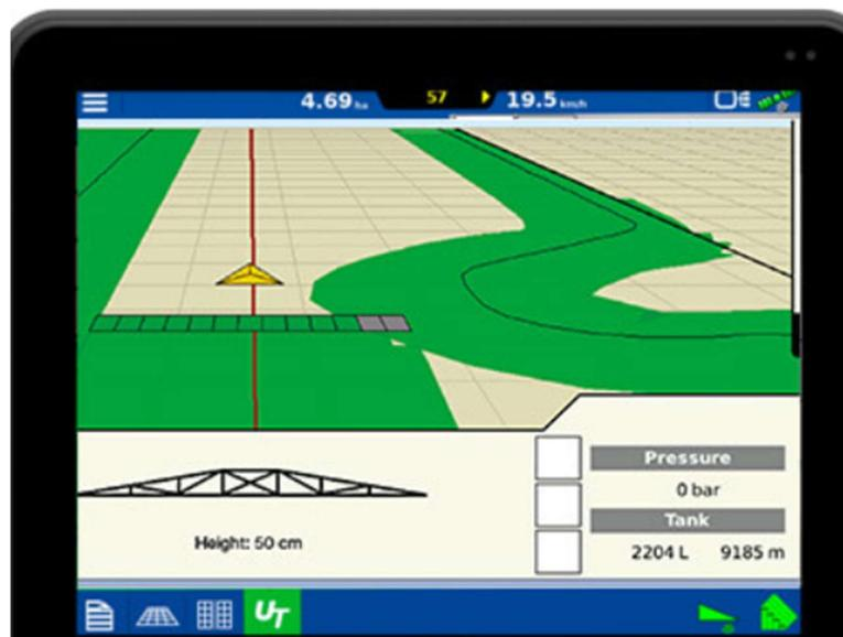
Slika 9. *AutoSectionControl* za automatsko otvaranje i zatvaranje mlaznica
