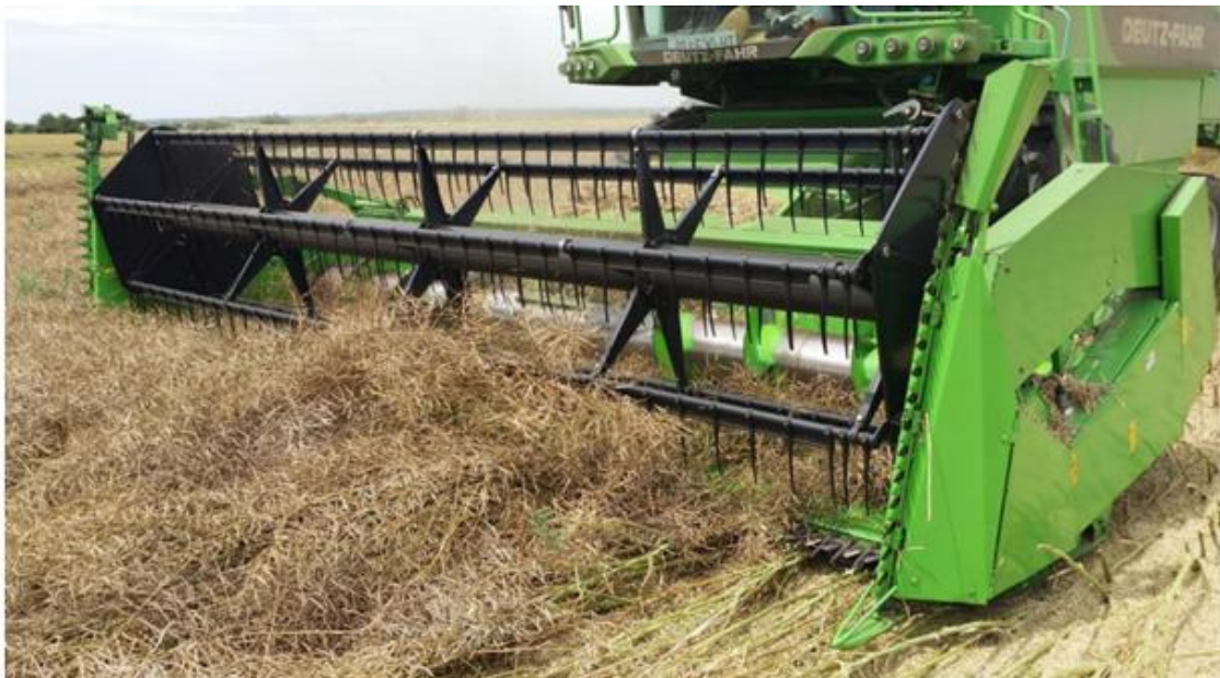
Slika 10. Stol za uljanu repicu s bočnim kosama (Izvor: slikao autor)
